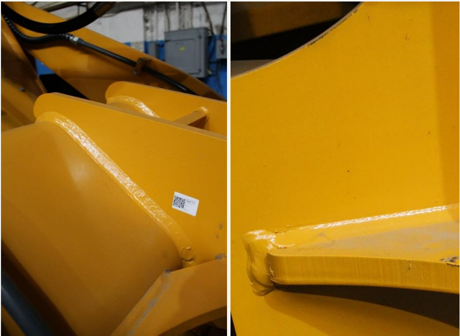
Высокое качество сварных швов
