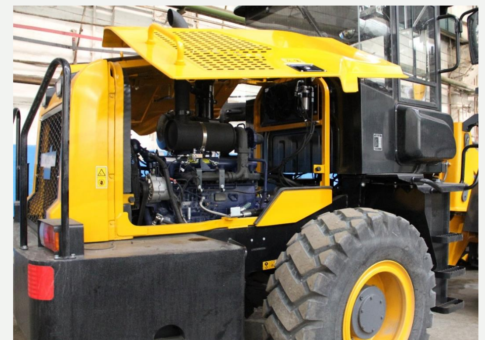
Хороший доступ для проведения ТО
