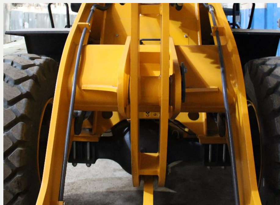
Оснащение 3й гидролинией
